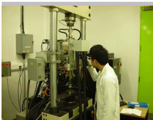
実験中（高温機械試験装置）
